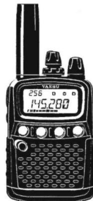
El **VR-120** de YAESU es un compacto receptor de telecomunicación de alto rendimiento, con una recepción de cobertura general de 100 kHz a 1299.995 MHz en los modos AM y FM (amplitudes de banda Ancha y Angosta); tal cobertura comprende las bandas de radiodifusión por AM y FM, las bandas HF de onda corta, las bandas de televisión VHF y UHF, la banda aeronáutica VHF por AM, así como una amplia gama de frecuencias comerciales y de seguridad pública!
